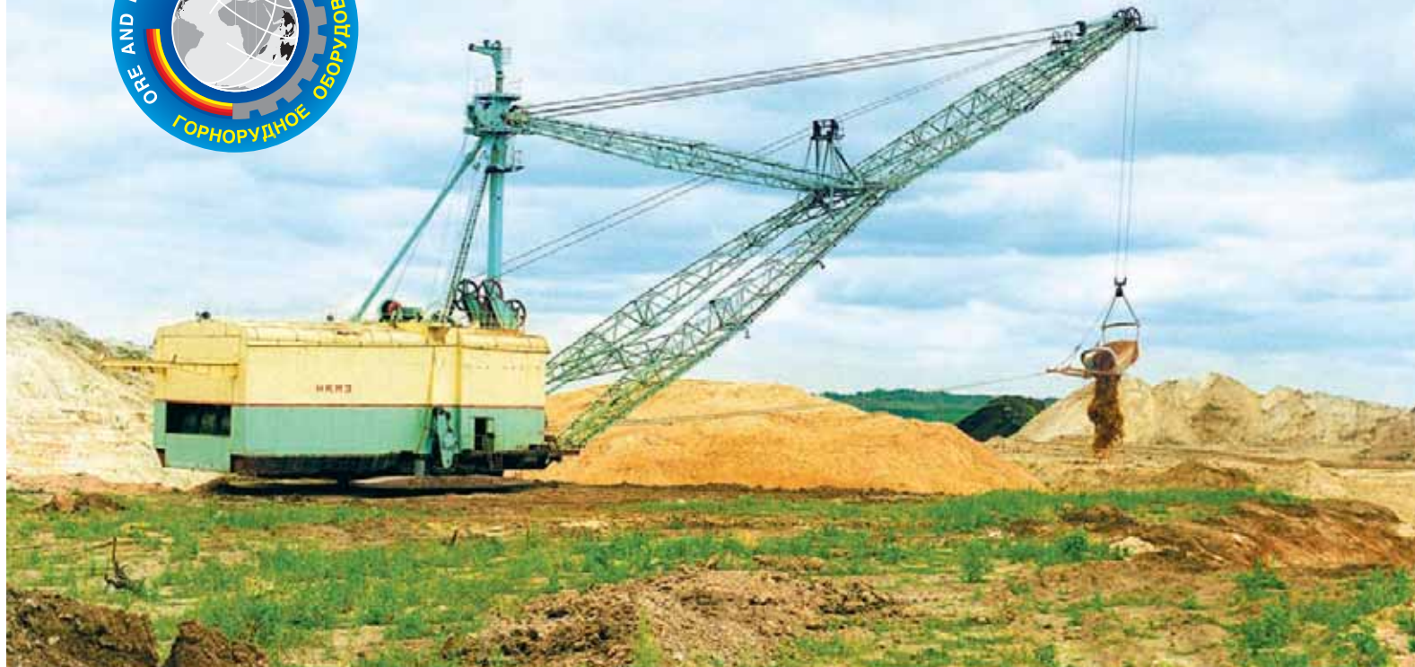
Экскаватор шагающий ЭШ-11/70 ЭШ-11/70 Walking Dragline
