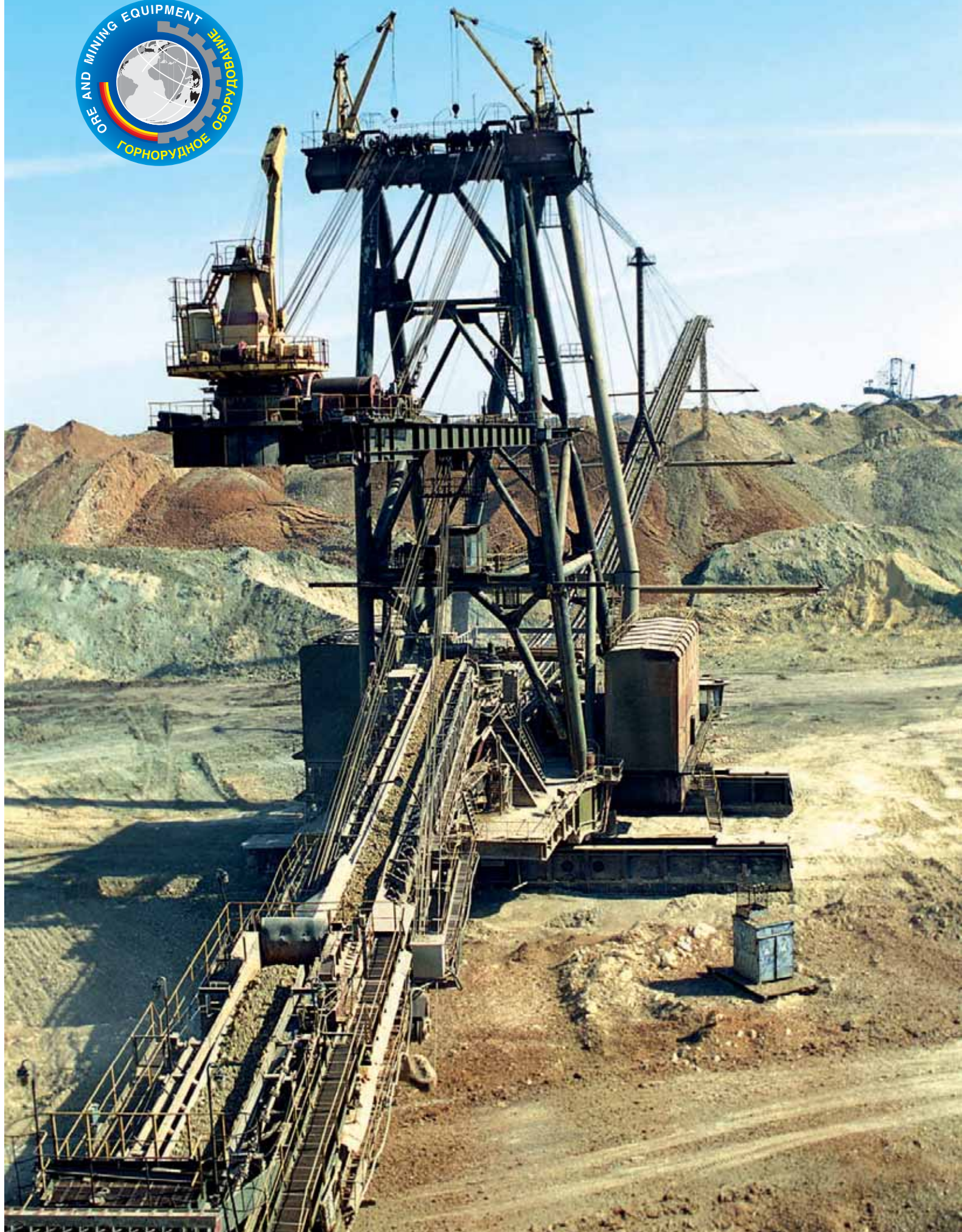
Отвалообразователь ОШР-5250/190 ОШР-5250/190 Stacker Reclaimer
