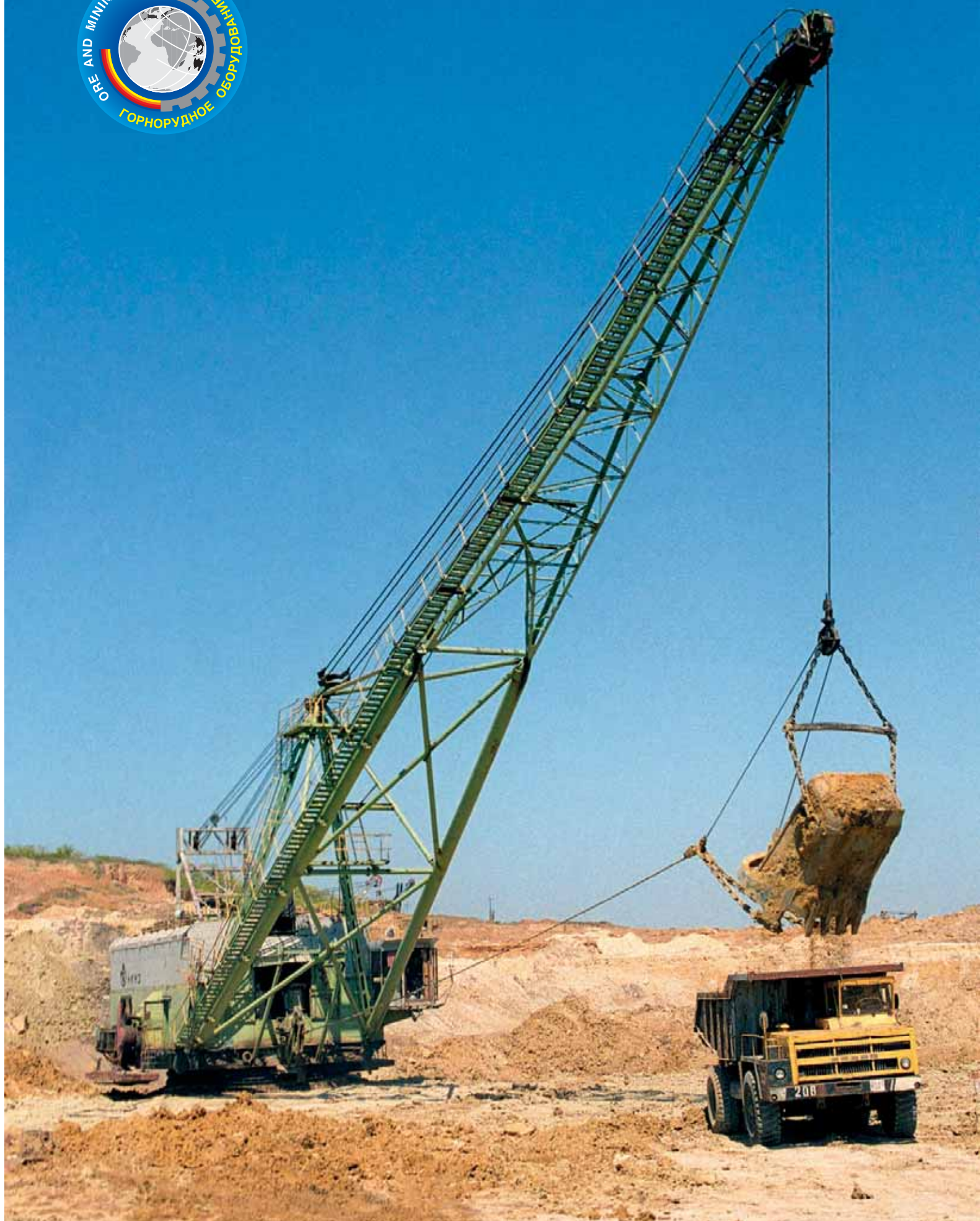
Экскаватор шагающий ЭШ-6,5/45 ЭШ-6,5/45 Walking Dragline
