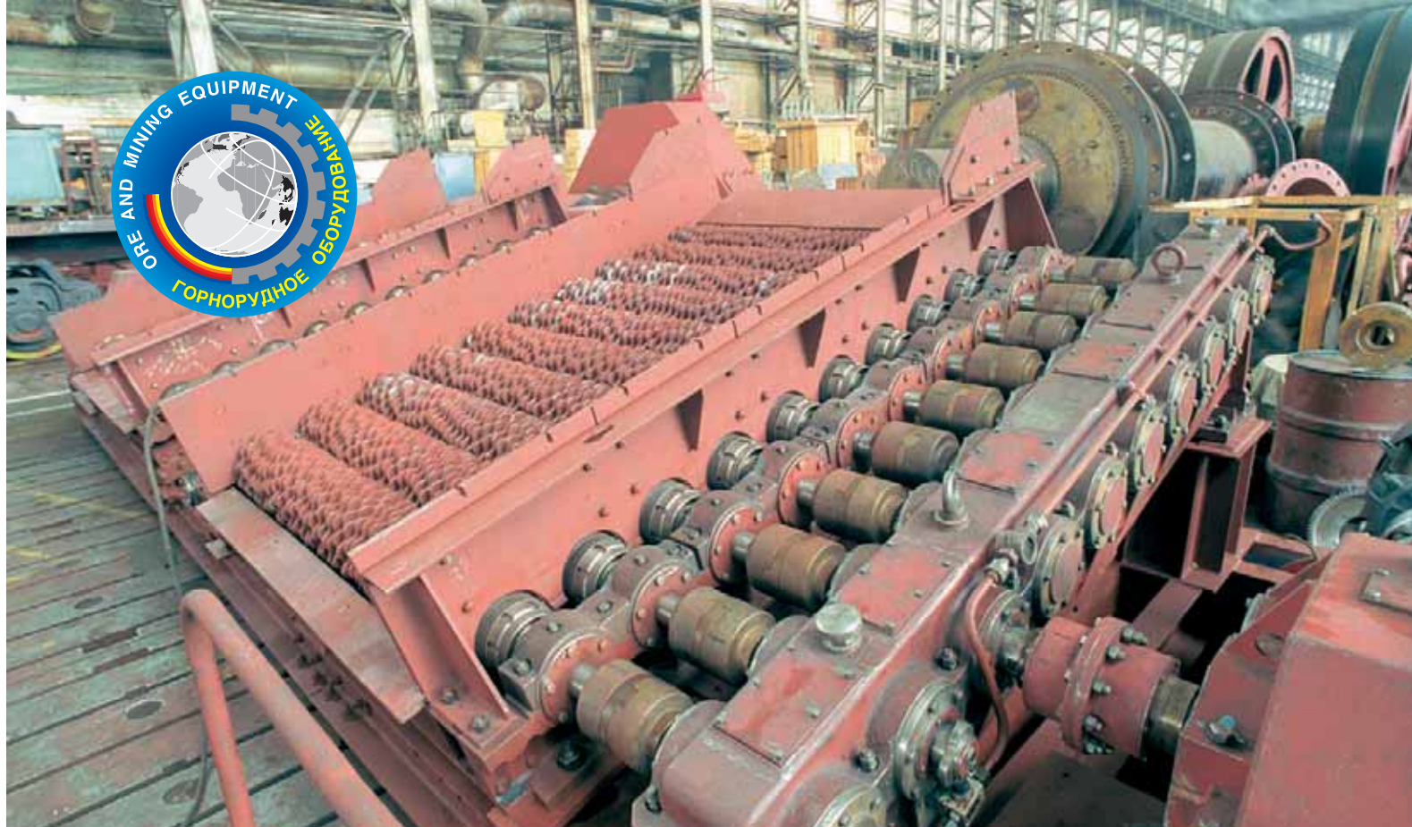
Грохот дисковый 2ГДП10х1,65-25 2ГДП 10x1.65-25 Revolving Disk Grizzly
