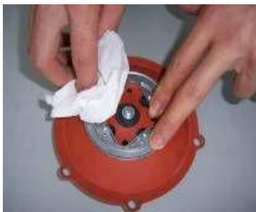
Рис. 5-11: Протрите узел диафрагмы.
