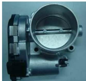
Рис. 5-14: Дроссельная заслонка с Электроприводом
