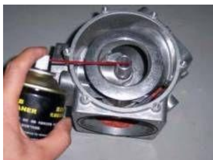
Рис. 5-7: Очистите держатель клапана
