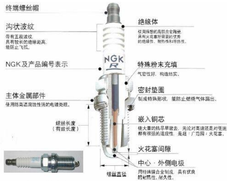
Рис. 5-16: Свеча зажигания NGK
