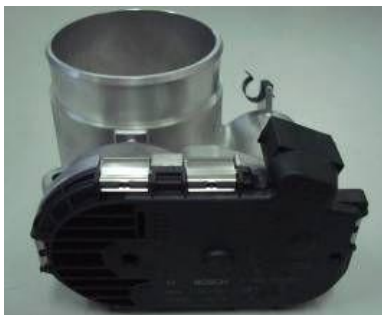
Рис. 5-14: Дроссельная заслонка с Электроприводом
