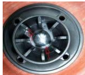
Рис. 5-12: Проверьте износ диафрагмы.
