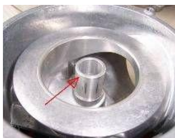
Рис. 5-9: Износ держателя клапана.
