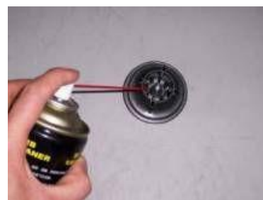
Рис. 5-10: Очистите направляющее отверстие и отверстие обратного давления
