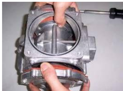
Рис. 5-5: Снимите крышку диафрагмы
