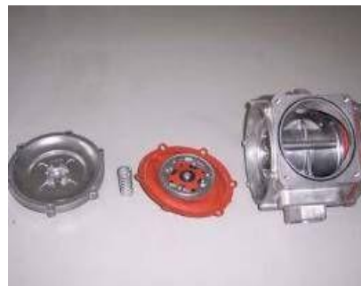
Рис.5-6:Снимите пружину и узел диафрагмы
